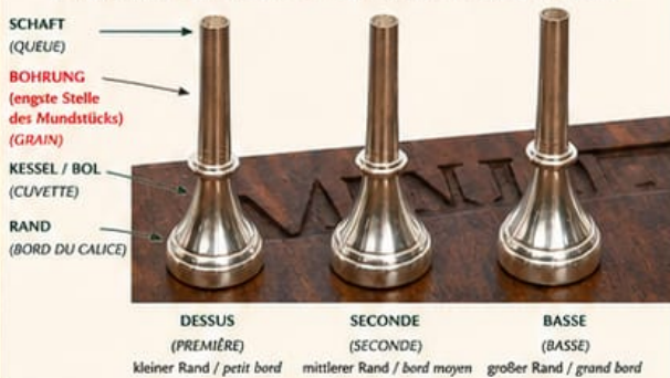
Abb. 22 Anatomie des Trompe-de-Chasse-Mundstücks, des „Embouchure“ (deutsch/französisch).
