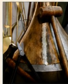
Abb. 25 Werkzeuge zur Herstellung eines Trompe-Pavillons aus der Werkstatt von Nicolas Poidevin. Der Schallbecher wird traditionell aus dünnem Messingblech von Hand ausgeschmiedet und anschließend sorgfältig ausgearbeitet.
