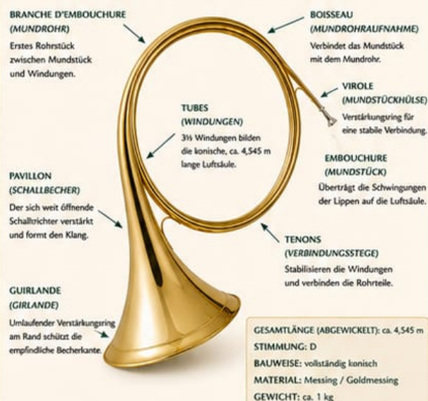
Abb. 21 Anatomie der Trompe de Chasse (französisch/deutsch).
